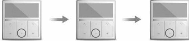
Drücken Sie den „Mode-Taste“, wechseln Sie zu manuellen Mode.
