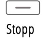
Motor unter Spannung nehmen (Motor fährt einmal und piept lang). Drücken Sie innerhalb von 10 Sekunden für 2 Sekunden die Stopp-Taste am neuen Sender (Motor ruckt zweimal und piept dreimal).
