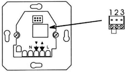
4. Schließen Sie die beiden Drähte des Sonnensensors an die Klemmen 1 und 3, wie unten dargestellt, an. Bitte beachten Sie, dass die Brücke zwischen Klemmen 1+2 bleiben muss. Der rot markierte Draht ist an der Brückenklemme 1 angeschlossen.
