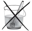
**Verlegen Sie das Anschlusskabel in einer Schleife nach unten, um zu verhindern, dass Wasser in den Antrieb läuft.**
