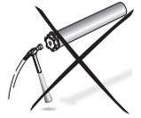
**Bohren Sie nie im Bereich des Antriebes. Zerstörungsgefahr des Antriebes.**
