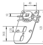
Fertigkastenlager m. Abrollfunktion
