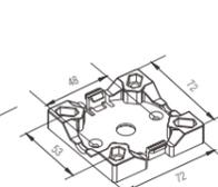
Schnellmontagelager 40Nm - 50Nm
