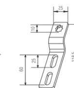
Fertigkastenlager m. Sternaufnahme
